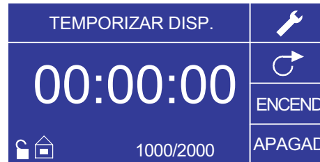
Figura 3-5. Operación en modo de descarga de tiempo
