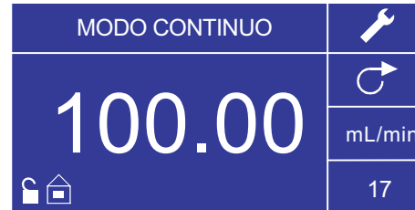
Figura 3-3. Operación en modo continuo
